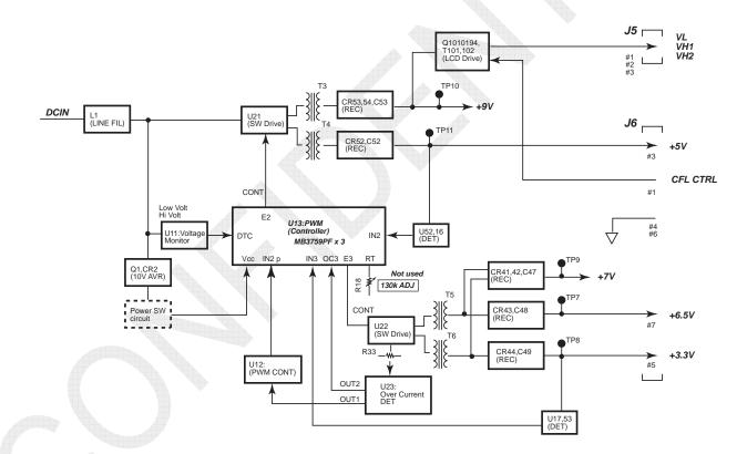
Fig. 7.10.5 PWR Board Block Diagram
