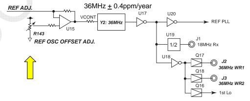
Fig. 5.7.17 REF OSC Block Diagram
