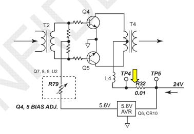
Fig. 5.7.13 DRV Board: Q4-Q5 BIAS Circuit
