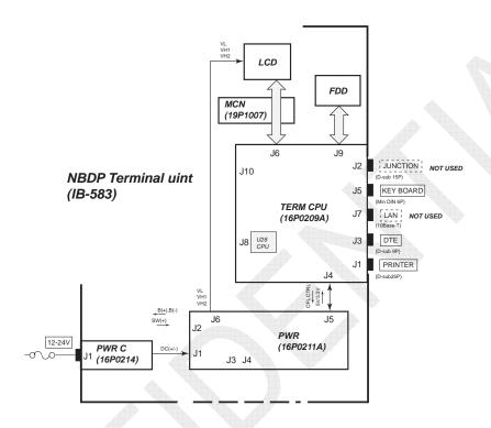
Fig. 7.10.3 IB-583 Block Diagram
