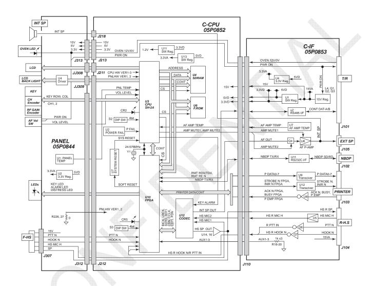
Fig. 7.8.1 FS-2575C Block Diagram
