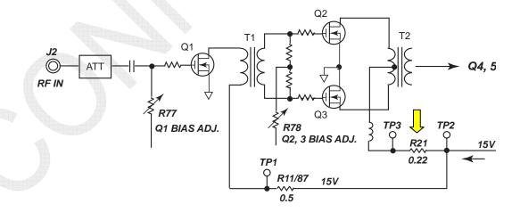
Fig. 5.7.14 DRV Board: Q2-Q3 BIAS Circuit
