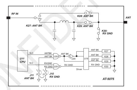
Fig. 4.12.1 AT-5075 Jumper Setting Circuit
